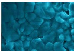
一般的なサーミスタは結晶構造そのものに高い容量性が付帯されています (複数のコンデンサが直並列に複数繋がるのと等しい状態)。その容量性 (Capacitance) には周波数が高くなるほど素子のインピーダンスを低下させる働きがあります。すなわち一般的なサーミスタの場合、印加信号の周波数 (または信号速度) が上昇すると抵抗値が急激に減少。サーミスタとしての温度検出機能が損なわれます。
